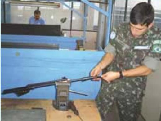
**General Câmara (RS)** - Em apoio ao Batalhão Haiti, o Arsenal de Guerra General Câmara recuperou, em apenas dois dias de trabalho, 40 Fuzis 7.62 M964 A1 – Parafal, com a substituição do cano e a realização de tiro técnico para aferição do sistema de mira.
